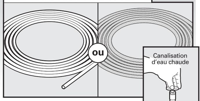
Mesurer la longueur totale nécessaire de tube de cuivre ou de tube de plastique (avec tressage de renforcement). Effectuer le raccordement sur la canalisation d'eau chaude avec un raccord ou autre dispositif conforme aux prescriptions des codes et règlements en vigueur. La canalisation d'arrivée d'eau devrait comporter un robinet d'arrêt manuel.
